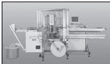
Котакх Alpha 433 S с двумя модулями уплотнителя и двумя модулями опрессовки
